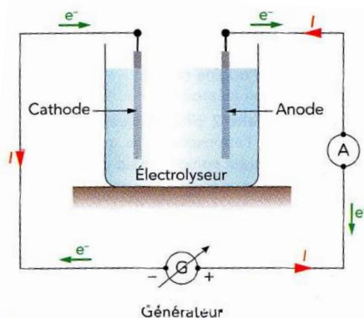
Le sens du courant dans le circuit est imposé par le générateur.
